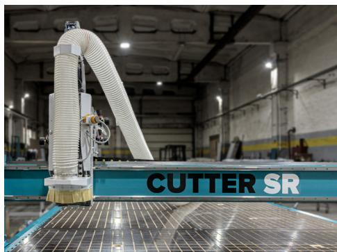
Благодаря использованию реечной передачи данная серия станков имеет большой ряд рабочих полей от размера 1550x1550 мм до размера 2070x4100 мм. Рабочий ход оси Z 220 мм.
