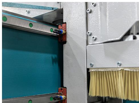
На станке установлены профильные направляющие серии GHR20, что обеспечивает точность и жёсткость перемещений.
