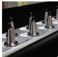
Имеет конструкцию, позволяющую исключить попадание стружки и СОЖ на патроны с инструментом.
