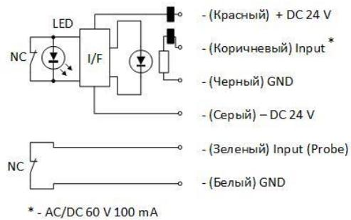
Прибор имеет шести проводное подключение: +24V , -24V, Gnd, Out (Input\*), Gnd, Out (Probe), . Во время работы на выходе Out присутствует напряжение , в момент нажатия кнопки фрезой, внутри прибора размыкается контактная пара - напряжение на выходе Out (Input) становится равным нулю – происходит замедление движения фрезы. Дальнейшее размыкание выхода Out (Probe) приводит к установлению и записи параметров нуля.
