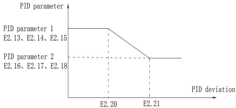
Diagram 5-33:PID parameter switch
