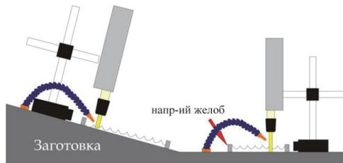
При вертикальной обработке большой заготовки опорная рама устанавливается непосредственно на заготовку. Под головкой создается направляющий желоб, чтобы охлаждающая жидкость могла течь наружу.
