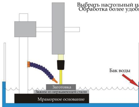
Используйте настольный набор, чтобы фиксировать заготовки. Это подходит для обработки малых заготовок. Во время работы разместите рабочий стол в баке воды, чтобы избежать потери охлаждающей жидкости.
