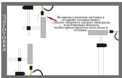
Для обработки внутренней стенки большой заготовки головка может устанавливаться на боковой стороне заготовки. При поперечной обработке следует обратить особое внимание на водоизоляцию головки.
