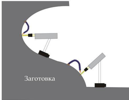
Для крупногабаритных заготовок аппарат может быть установлен непосредственно на обрабатываемой поверхности. Положение головки может быть отрегулировано в соответствии с потребностями.
