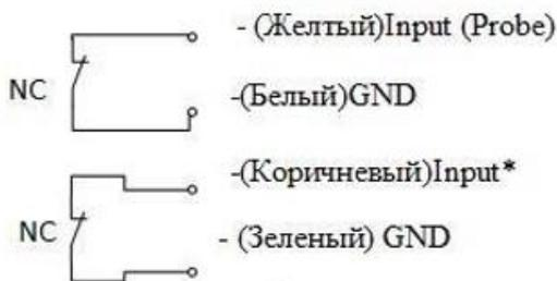
Прибор имеет четырех проводное подключение: Gnd, Out (Input\*), Gnd, Out (Probe). Другими словами имеет две контактные группы. Первая группа контактов расположена в верхней точке срабатывания датчика и отвечает за позиционирование инструмента. Вторая группа контактов находится в нижней мертвой точке хода
