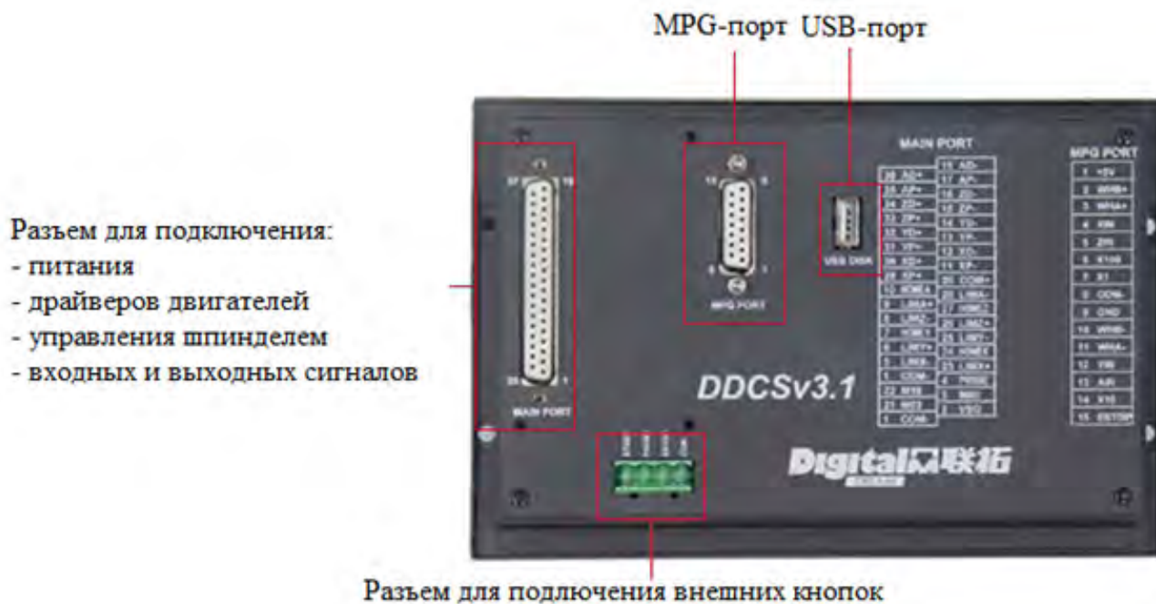
Рис. 2.1.1 Разъемы и порты контроллера
