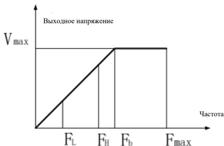
Рис. 7-1 Схема определения параметров частоты
