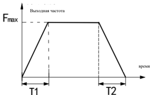
Рис. 7-2 Определение времени добавления/замедления
